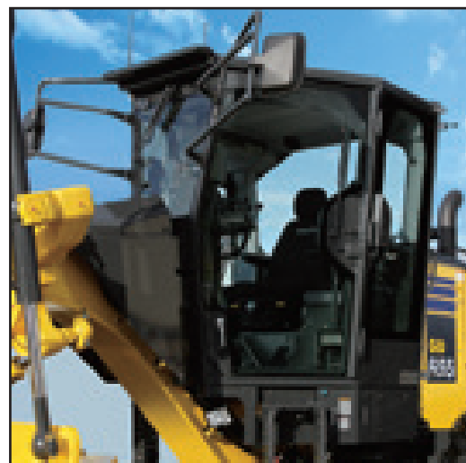
Cabina com estrutura protetora anti-capotamento (ROPS), equipada com lavadores e limpadores com velocidade intermitente
